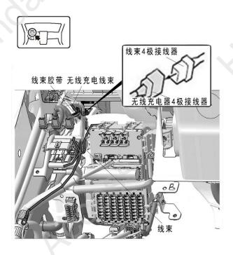
26. 拔出车辆 28 极与保险丝盒背面的 18 极接线器,拆出车辆预留的 4 极接线器。
