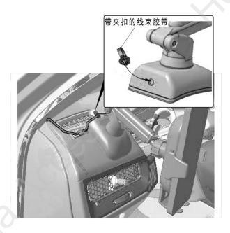
25. 连接无线充电器线束的 4 极接线器并固定。
