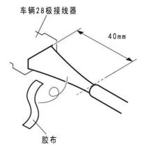
28. 连接线束的导线与车辆 28 极接线器。
