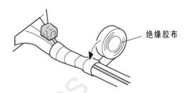
35. 剪开步骤 25 拆出的车辆 4 极接线器的胶布。
