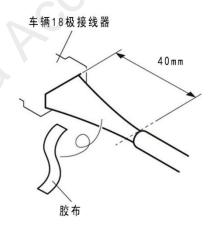
32. 连接线束的导线与车辆 18 极接线器。
