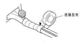
31. 剪开步骤 25 拔出的车辆 18 极接线器的胶布。
