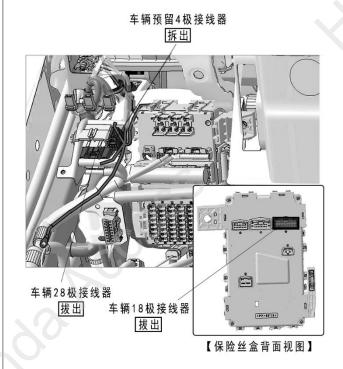
27. 剪开步骤 26 拔出的车辆 28 极接线器的胶布。
