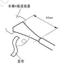
36. 连接线束的导线与车辆 4 极接线器。
